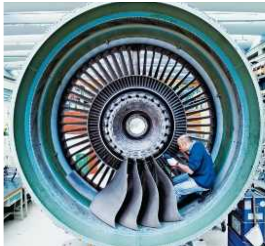
Konventionelle Triebwerksschaufeln bestehen aus vielen einzelnen Bauteilen.
